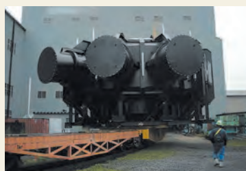
大型鋼構造物の輸送 工場搬出～埠頭
