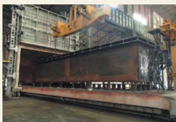
大型鋼構造物のSR(焼鈍)
