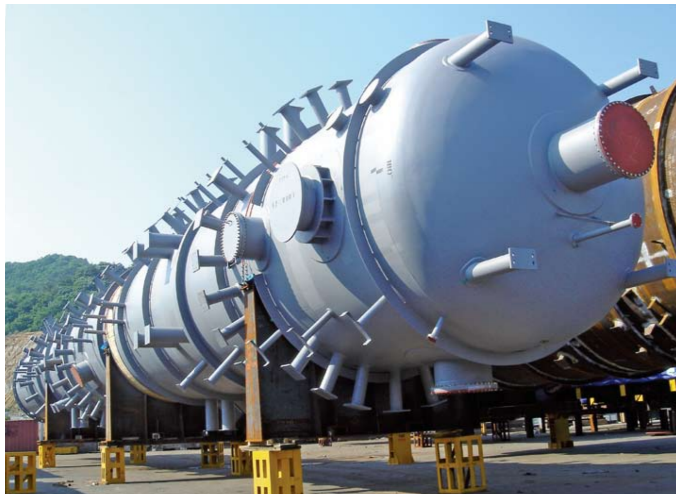
▲Hydrotreater Reactor / 反応器
